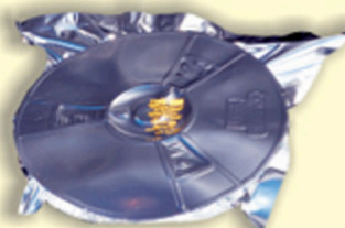
Busta barriera sigillata con una eccessiva evacuazione d'aria.
