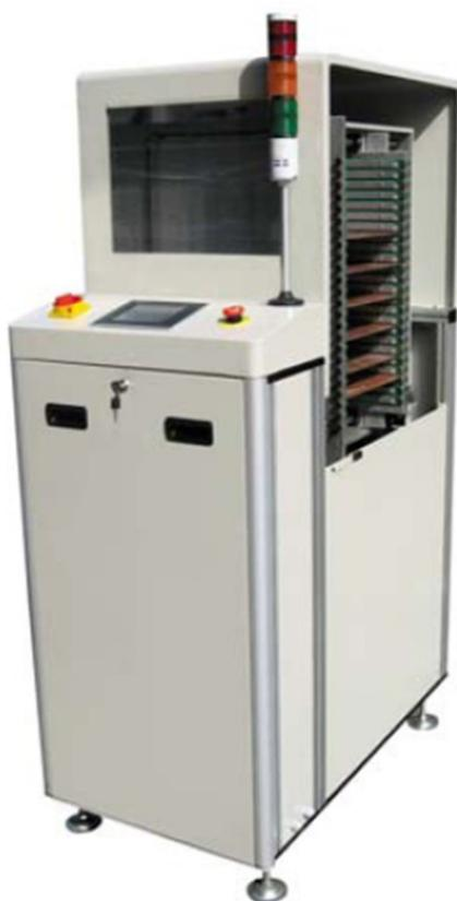
Il buffer FIFO è un modulo intelligente che fa da polmone all'interno di linee ad alta velocità.
